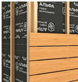
Рис. 2. Монтаж с зазором более 5 мм между изделиями.
